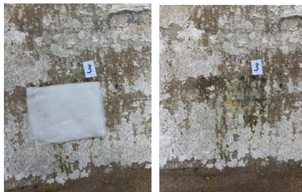
Рис. 3. Підбір методу зняття тиньку. Проба № 3
