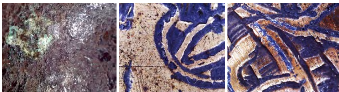
Іл. 2. Макрофотографії фрагментів тазу для вмивання (Інв. № 156 БВ) (збільшення x 50): а – зелена, чорна та коричнева патина; б, в – коричнева патина і чорний органічний матеріал на зовнішній поверхні.
