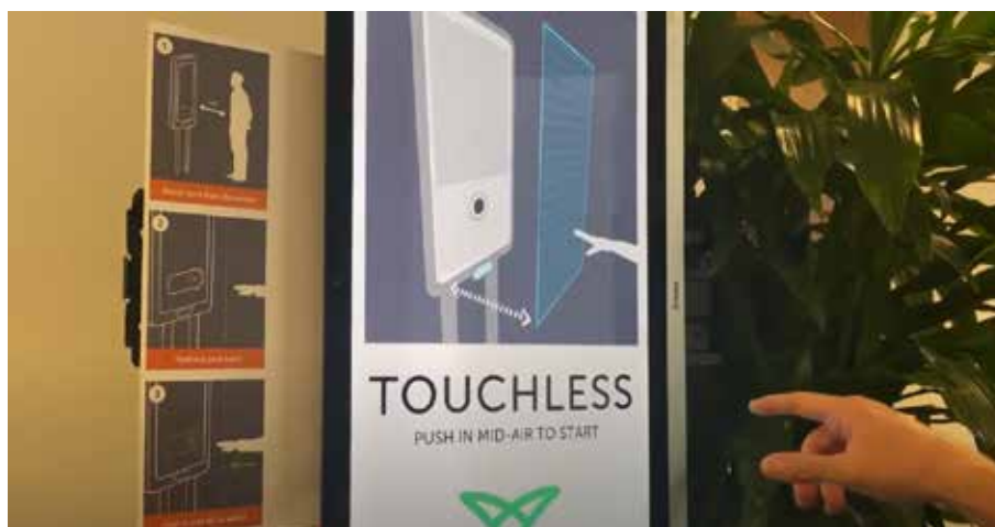
Рис. 4. Кіоск Ultraleap, створений для безконтактної жестової взаємодії в умовах Covid-19
