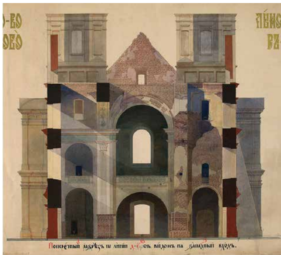
Рис. 3. А. Прахов. Поперечний розріз Успенського собору із західної сторони
